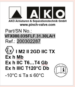
Пример: пневмоуправляемый пережимной клапан по ATEX
