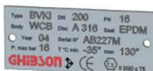
В соответствии с PED директивой все без исключения дисковые затворы оснащены металлической идентификационной табличкой с информацией о производителе, стране изготовления, серийном номере изделия, температурных характеристиках, рабочем давлении и т.д.
