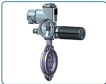
Дисковые затворы серии BVKI в сборе с электроприводом AUMA с однофазным электродвигателем переменного тока Ду 40 - Ду 300. Привод подобран для давления внутри затвора не более 10 бар\*.
