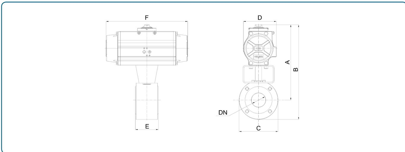
Арт. 8P004100 Шаровой кран модели 720232 в сборе с пневмоприводами двойного действия. Привод подобран для давления управления 6 бар.
