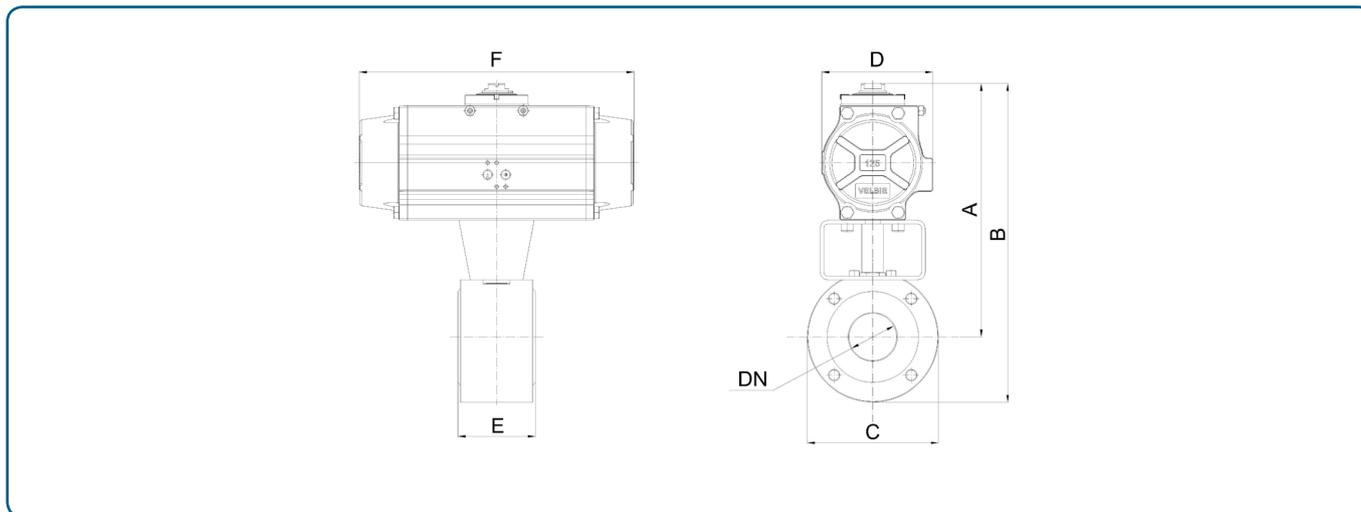
Арт. 8P004100 Шаровой кран модели 720232 в сборе с пневмоприводом двойного действия, покрытым PTFE. Привод подобран для давления управления 6 бар.
